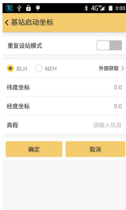
图 3-11 基站启动坐标设置
