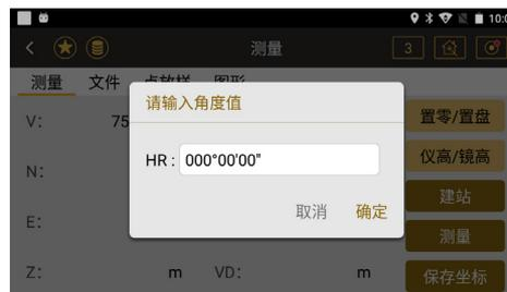
●仪高 / 镜高: 输入仪器高度和棱镜高度
