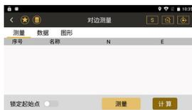
② 点击“测量”，将镜头对准测量点，点击“测角 & 测距”，保存再点击完成返回上一界面。
