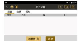
② 选择“测量”选项，进行第一个控制点的输入和测量工作。在点名一栏输入控制点点名，镜高一栏输入棱镜高度，然后对准棱镜选择“测角 & 测距”，然后点击“完成”。
