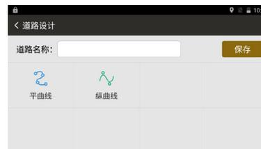
◆平曲线：平曲线指的是在平面线形中路线转向处曲线的总称。包括圆曲线和缓和曲线。连接两直线间的线，使车辆能够从一根直线过渡到另一根直线。平曲线分为三种方法交点法、元素法、坐标法。
