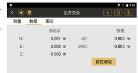
④ 点击“前往建站”，输入测站名并照准最后一个测量点，点击“设置”则建站完成。
