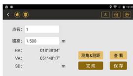
③ 将镜头对准第三个点，点击测量，屏幕中间显示的为起始点与该点之间的距离信息。
